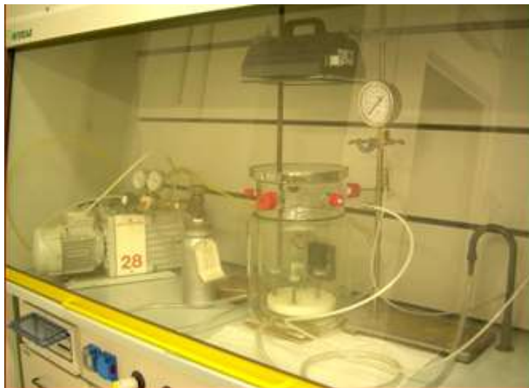
Il reattore chimico per studi di fotocatalisi con TiO_2
