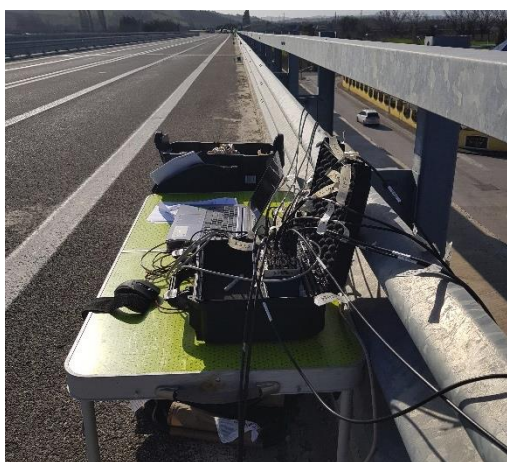
Figura 1 Esempio di indagine dinamica su un viadotto eseguita nel Febbraio 2020 da personale del Laboratorio di Dinamica delle Strutture per conto di ANAS impiegando la strumentazione acquisita nell'ambito del Progetto del Dipartimento di Eccellenza.
