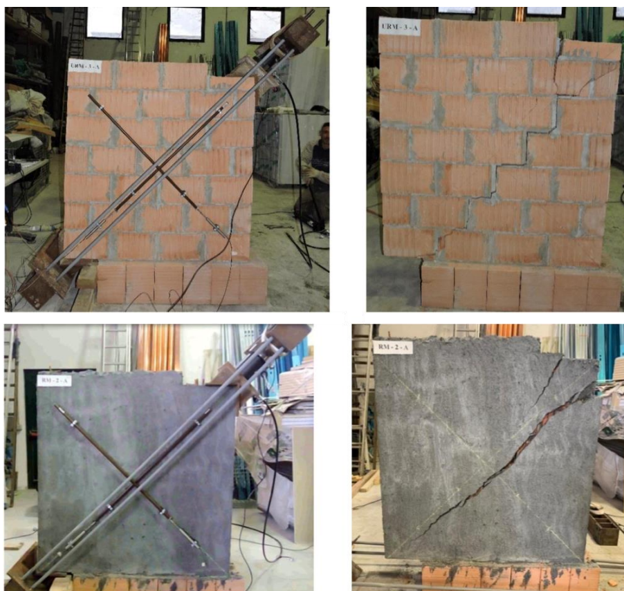
Figura 4 Esempio di prove di compressione diagonale per la determinazione della resistenza a taglio del solido murario effettuata su pannelli in muratura ordinaria e pannelli in muratura rinforzata per mezzo di malta fibrorinforzata.
