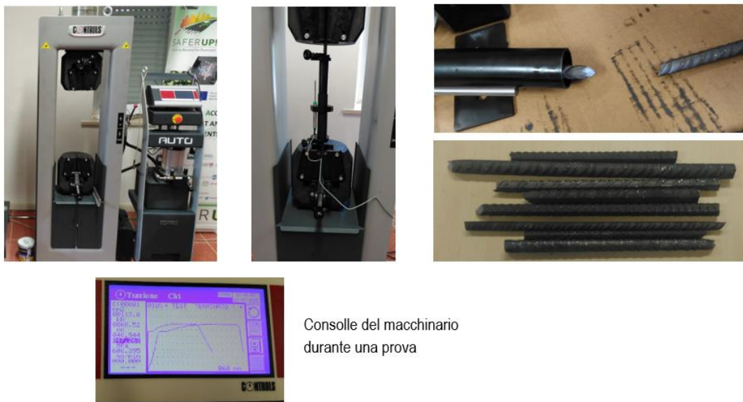
Figura 3 Macchina per prove a trazione su barre di acciai da calcestruzzo armato ad aderenza migliorata acquistata nell'ambito del Progetto di Sviluppo del Dipartimento di Eccellenza.
